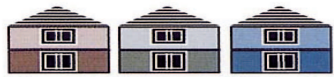
建物の色を同一または類似するトーンでそろえて色相に変化を持たせる
